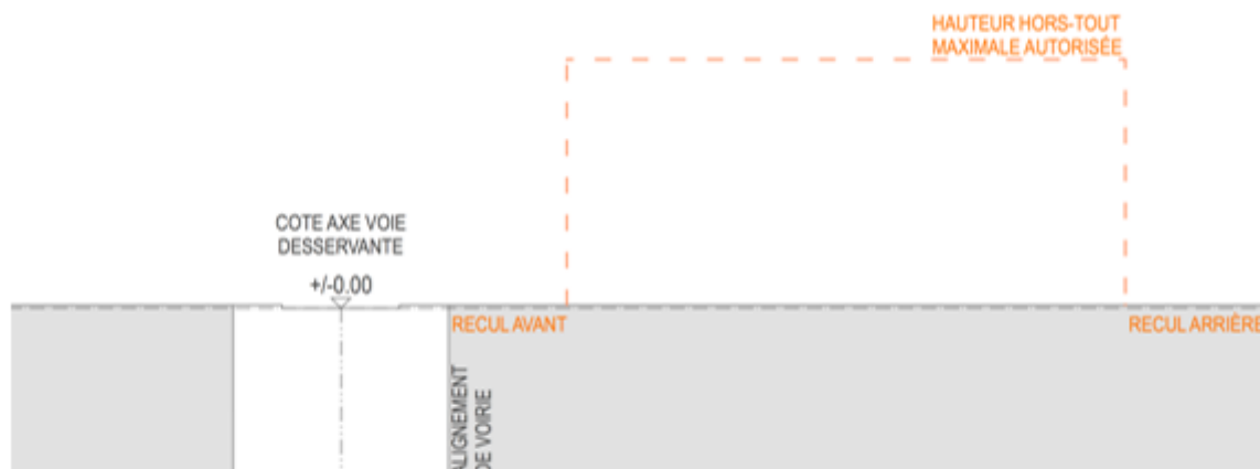
Figure 15.20.3 : Vue en coupe du gabarit de construction maximal autorisé des quartiers existants situés dans les zones MIX-r, GARE, REC BEP, ECO-c1 et 2, COM et SPEC-1
