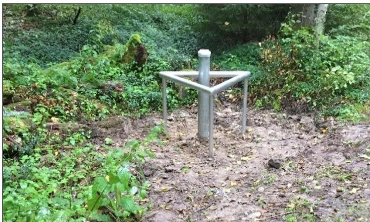
Abb. 4: Grundwassermessstelle mit Anfahrerschutz.
