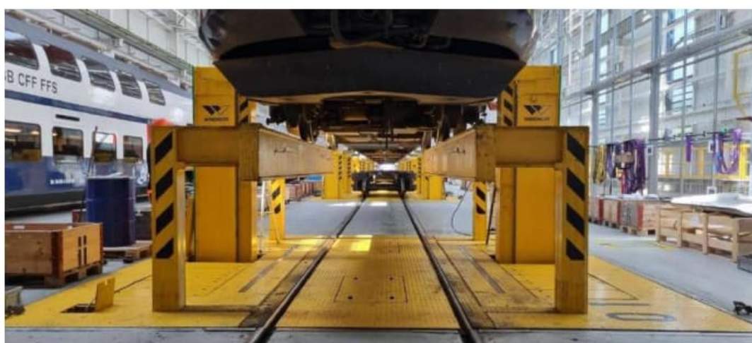
Figure 27 : Exemple de système de levage combiné rail-caisse
