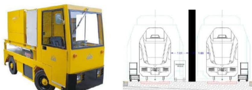
Figure 13 : Exemple de véhicule de sablage et coupe du stationnement (S.N.C.F.L.)
