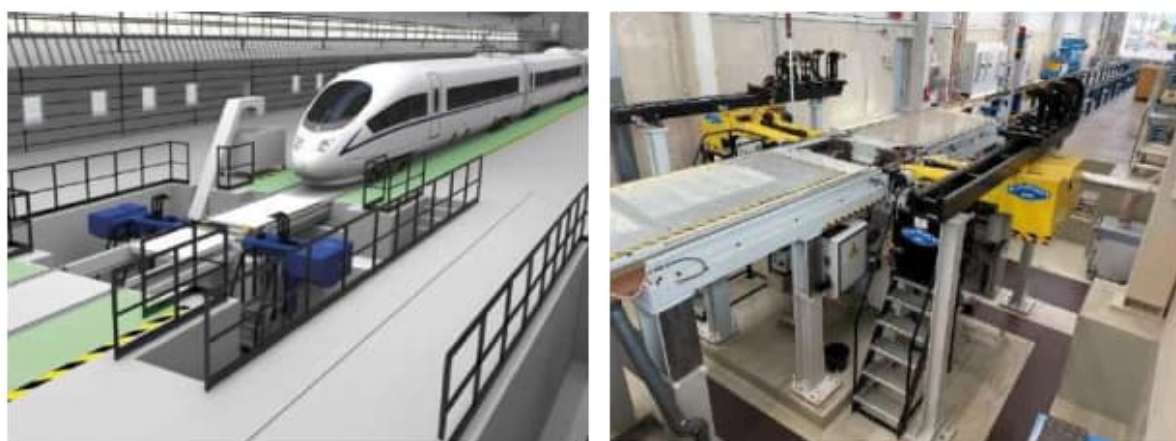
Figure 29 : Exemple de tour d'essieux montés sous châssis
