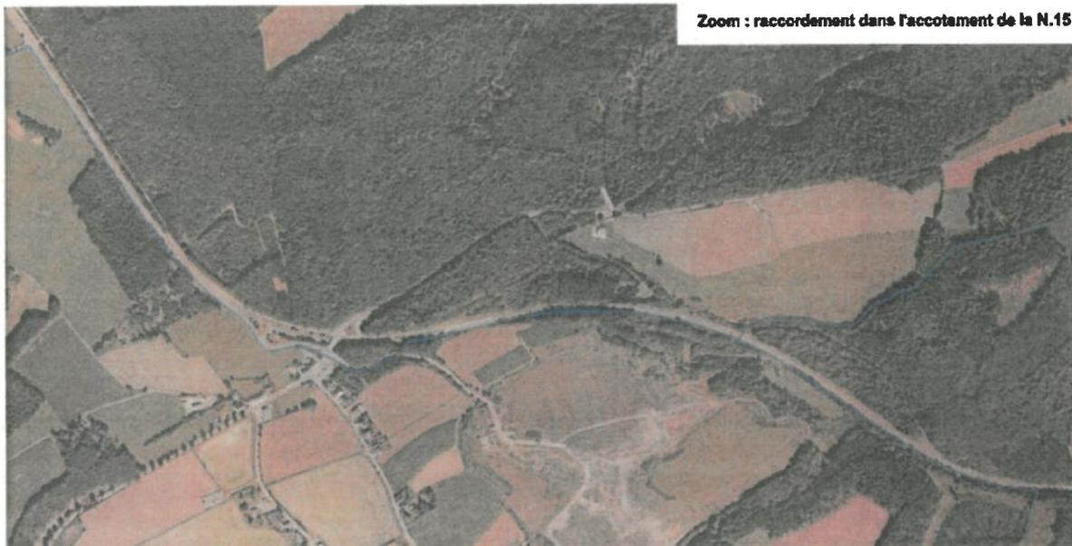
Cette variante n'est pas réalisable, en raison des caractéristiques naturelles (talus). L'envergure des travaux nécessaires pour la réalisation d'une tranchée de 1,50 m de largeur est trop importante. De plus, une conduite d'eau de la « DEA – Distribution d'Eau des Ardennes » est déjà présente dans l'accotement.
