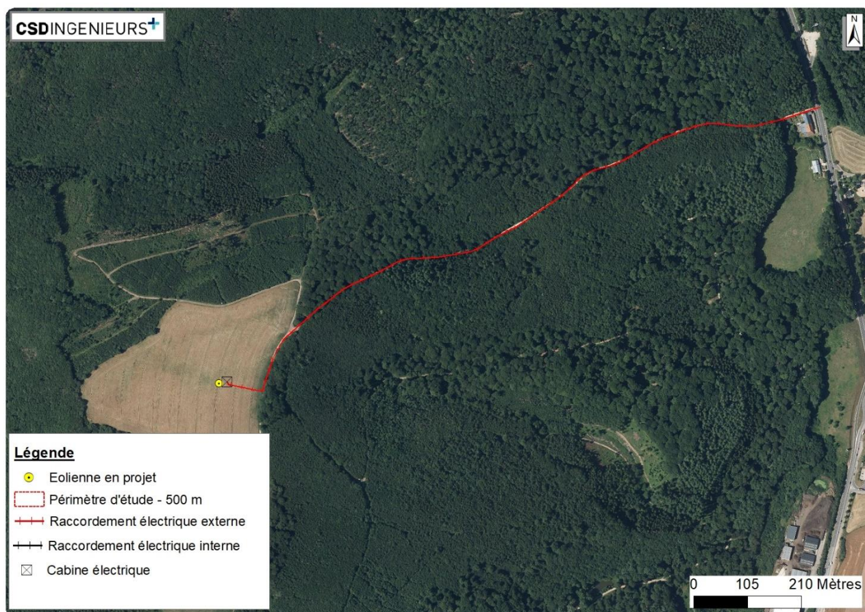
Figure 61 : Raccordement électrique externe du projet éolien.
