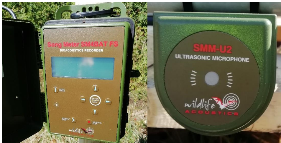
Figure 30 : Détecteur de type « SM4BAT FS » et micro à ultrasons de type « SMM-U2 ».
