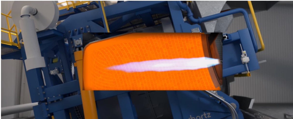
Seitenansicht-Schnitt eines Bartz Kipptrommelofens mit variablen Gas-Sauerstoff-Luft Brenner. Flamme ist einstellbar in Länge, Form, Temperatur und in der Ausrichtung
