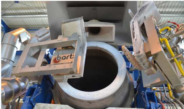
Vorderansicht eines Bartz Kipptrommelofens mit Doppelhaubensystem. Türabsaughaube zur Absaugung während des Schmelzvorganges – große Haubenabsaugung für den Chargier-, Abschlack-, und Reinigungsprozess des Ofens
