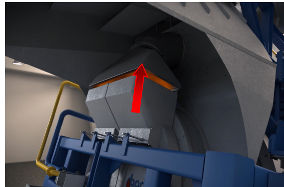
Vorderansicht eines Bartz Kipptrommelofens mit Doppelhaubensystem. Türabsaughaube zur Absaugung während des Schmelzvorganges – große Haubenabsaugung für den Chargier-, Abschlack-, und Reinigungsprozess des Ofens
