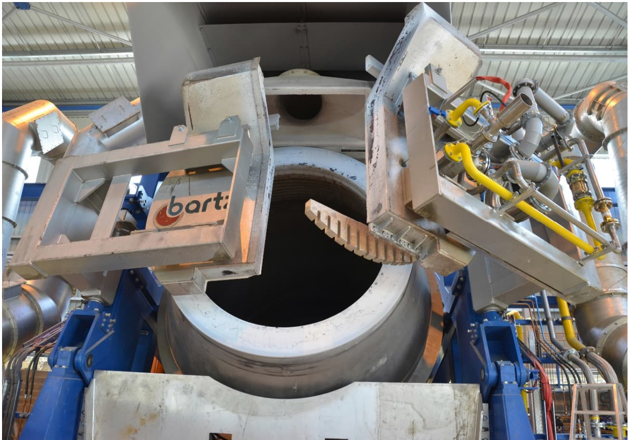
Vorderansicht eines Bartz Kipptrommelofens mit Multifunktionstür und integriertem Gas-Sauerstoff-Luft Brenner, Schlackerechen, sowie separaten Absaugsystemen für Ofeninnenraum und Vorzone.
