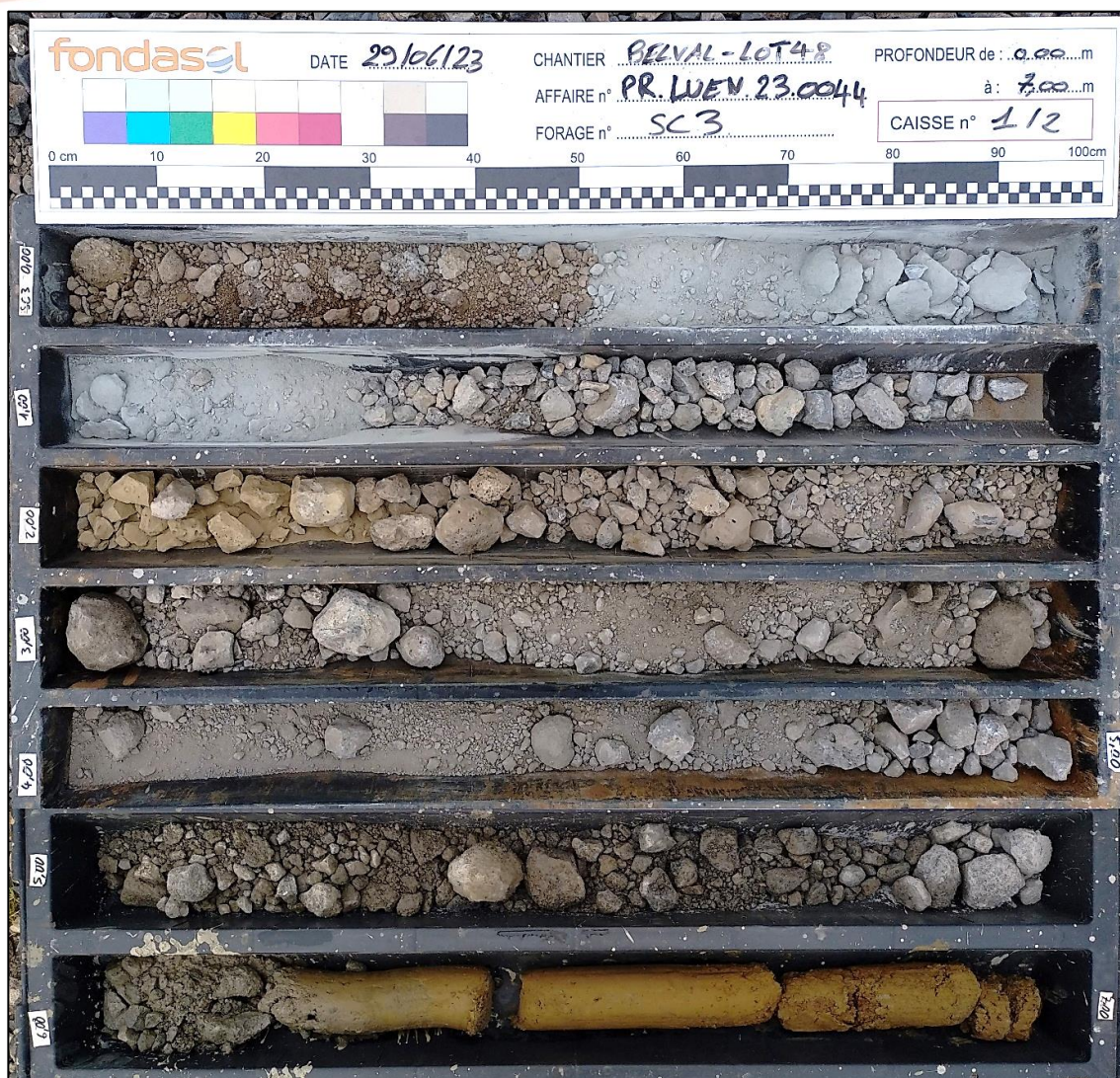
Sondage carotté SC3 réalisé de 0,00 m à 7,00 m de profondeur
