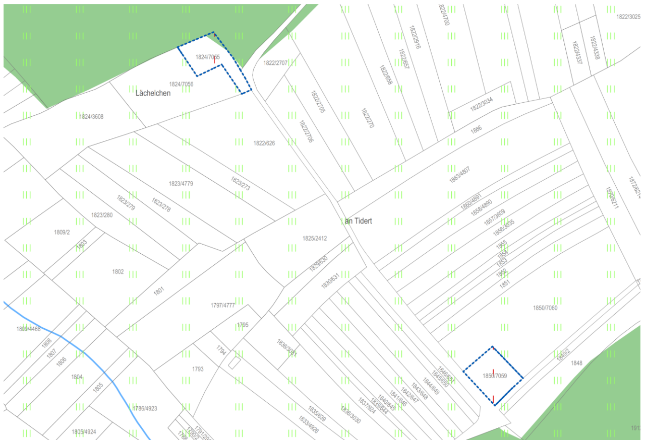
Abbildung 4: Darstellung der beiden geplanten Neubrunnen (SH-15-6 und SH-15-7), die bereits als ZPSI der ausgewiesenen Trinkwasserschutzzone (blau) dargestellt sind. Quelle: Dewey Müller, 2020
