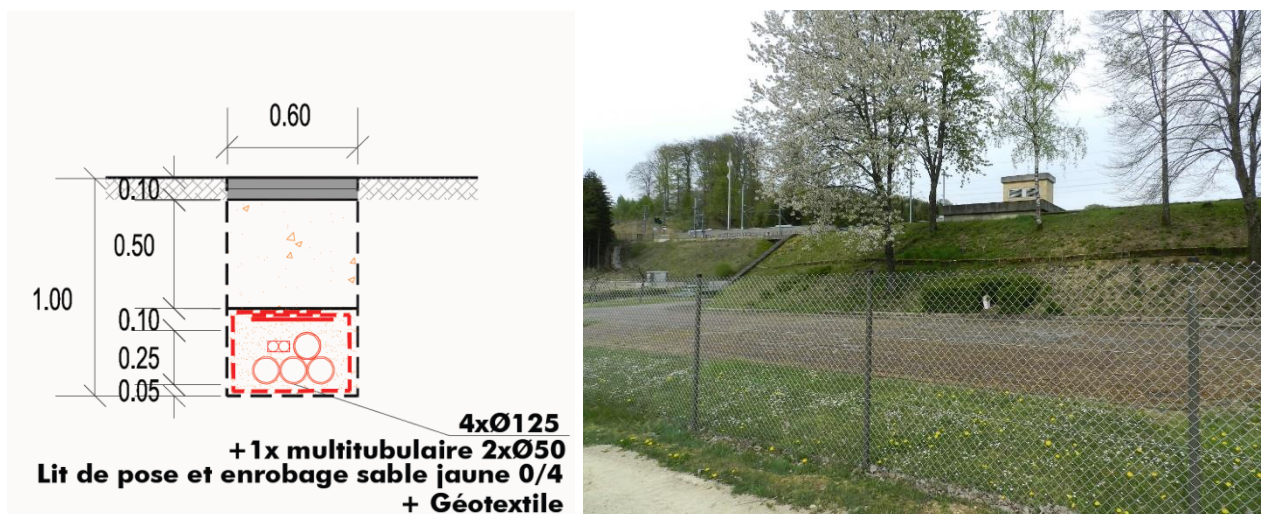
Abbildung 50: Schnitt im Bereich des Bauabschnitts 8 für die Verlegung von Leerrohren. Quelle: TR-Engineering, 2019 (links) und Blick von Süden auf das Gelände des Wasserwerkes, auf dem die Verlegearbeiten durchgeführt werden. Quelle: CO3, Mai 2020.
