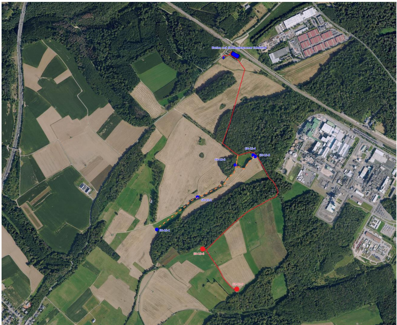
Abbildung 6: Übersichtsplan Notversorgungsstandort Scheidhof mit den bestehenden Anlagen von Wasserwerk, Schieberkammer und Brunnen (blau), der Bestandsleitung (orange) sowie den neuen Leitungen und Brunnenanlagen (rot). Quelle: geoportail.lu, eigene Darstellung CO3, 2023
