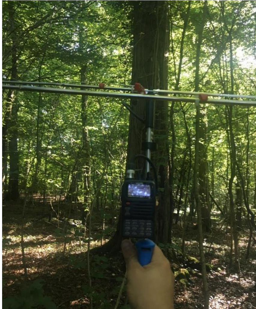
Abbildung 6: Telemetrie-Anlage zur Quartierermittlung
