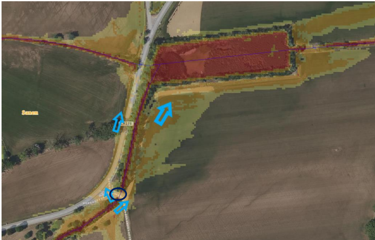
Abb. 67: Auszug aus dem hydrologischen Gutachten (Luxplan S.A. 2024): die Überführung ist blau umkreist, die blauen Pfeile markieren schematisch die Fließrichtung des Starkregenabflusses.
