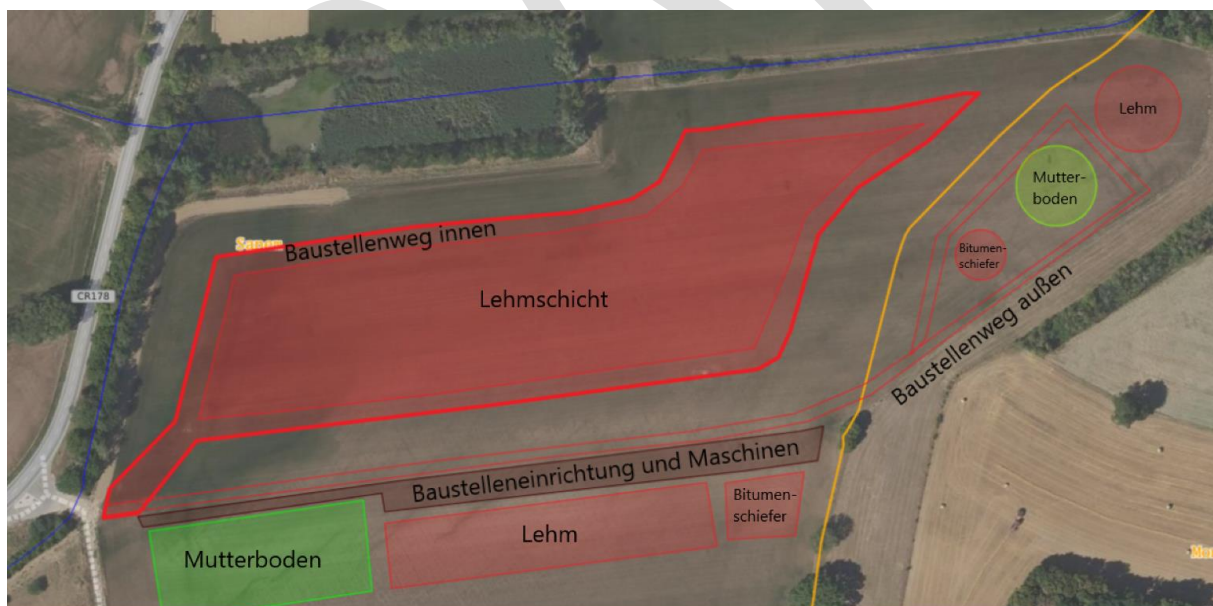
ABBILDUNG 23 : PRINZIP DER BAUSTELLENPHASEN
