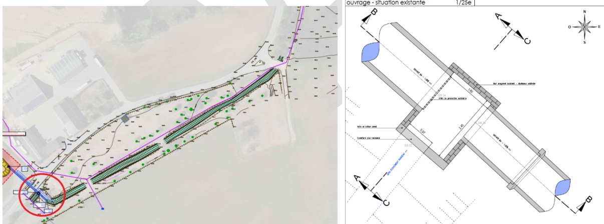
ABBILDUNG 19 : ANSCHLUSSKAMMER DER WSA NIEDERSCHLAGSENTWÄSSERUNG IN DEN KLAUSBACH
