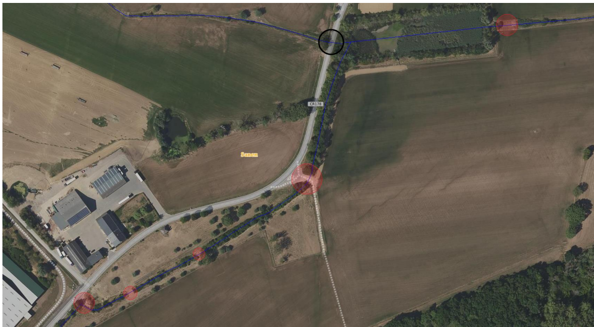
Abb. 56: Auszug aus dem hydrologischen Gutachten (Luxplan S.A. 2024): Lokalisierungen der Bachüberbauungen/Querungen (rote Kreise). Der Verrohrung des westlichen Zulaufs unter dem CR178 ist als schwarzer Kreis dargestellt.
