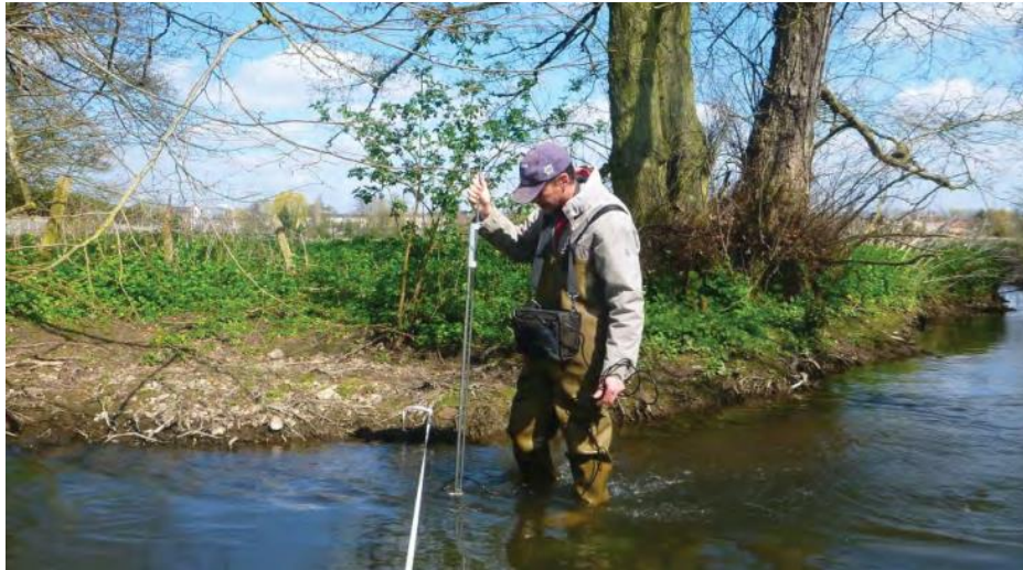
Figure 6: Mesure de débits en rivière avec le vélocimètre (Luxplan)
