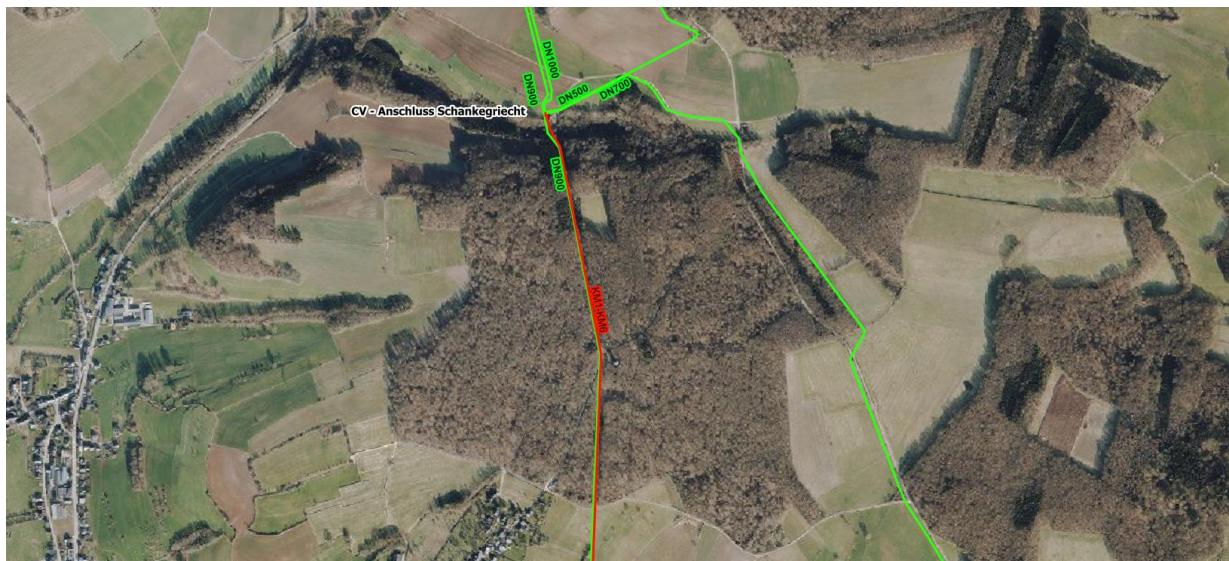
Abbildung 4: Anschlusssituation Schieberkammer Schankegriecht – Verlauf Bestandsleitungen und geplanter DN1100-Leitung
