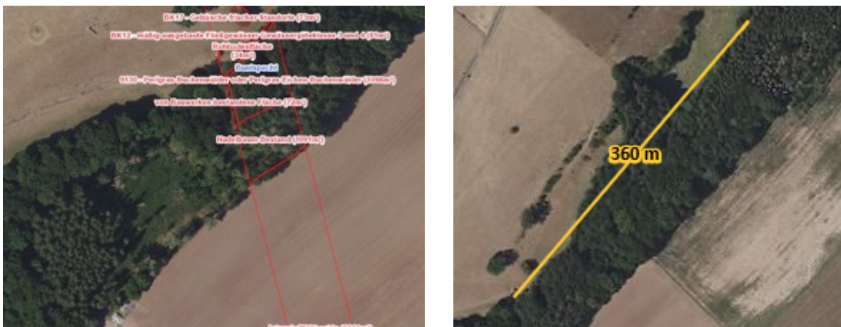
Abbildung 63: ursprüngliche Trassenführung in der Teilfläche B-Nord bei Km 4 (links). Nach Nordosten verlagerter Verlauf durch die Trassenoptimierung (rechts)
