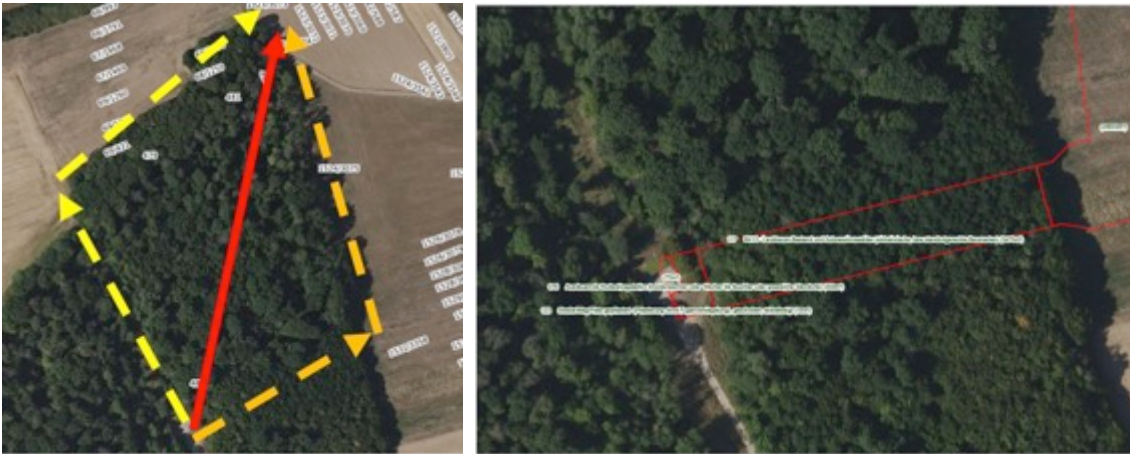
Abbildung 67: Links vorgeschlagene Optimierungsmöglichkeiten (gelb/orange) des geplanten Trassenverlaufes (rot) und rechts Ergebniss der Trassenoptimierung (Bildquelle: efor-ersa).
