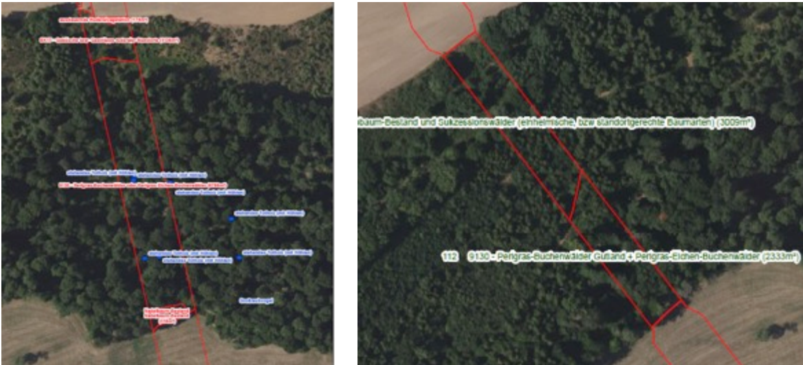
Abb. 68: Ursprünglich geplanter Trassenverlauf bei Km 14 (links) und optimierter Verlauf (rechts). Bildquelle: efor-ersa)
