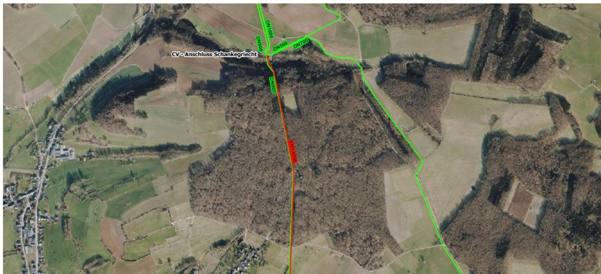
Abbildung 5: Anschlusssituation Schieberkammer Schankegriecht – Verlauf Bestandsleitungen und geplanter DN1100-Leitung
