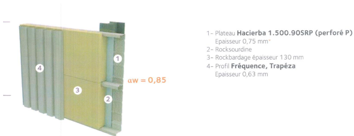
Fig. 26: Détail du traitement acoustique interne (Source : Arcelor Mittal Performance des bradages Globalwall – Rockbardage)
