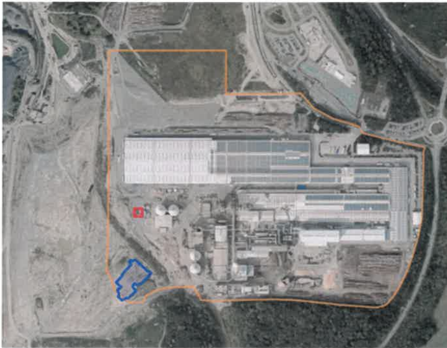
Figure 5 du rapport d'évaluation révisé « Orthofoto 2021 – Luftbild zu den bestehenden Betriebseinheiten des Werkes von KRONOSPAN inkl. Standort der CHP III (blau) und des Bindemittelagers (Rot). Der Umring des gesamten Werkes, wie es sich nach der geplanten Erweiterung darstellen soll, ist orange umrandet. (Quelle: Géoportail 2021) »
