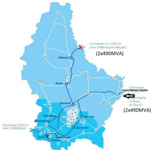
Das Hauptziel war es, unter strengen Betriebsbedingungen die erzeugten Magnetfelder abzuschätzen und zu überprüfen, ob diese im akzeptablen Rahmen bleiben. Im normalen Betriebsmodus des Netzes sind beide Versorgungsachsen in Betrieb, sodass die gesamte (verbrauchte und transitierte) Leistung, wie bereits erwähnt, durch die schwächere der beiden Achsen begrenzt wird.
