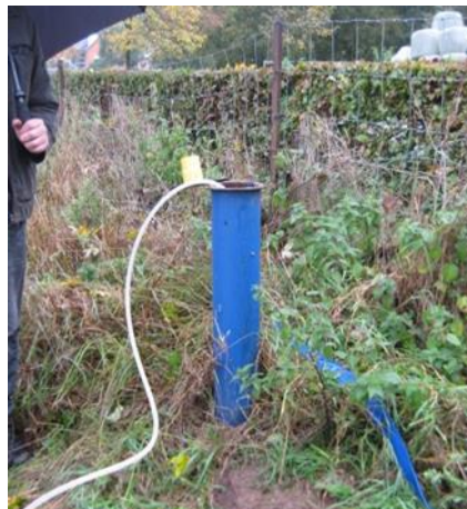
Figure 2 : forage de reconnaissance protégé par un tube métallique
