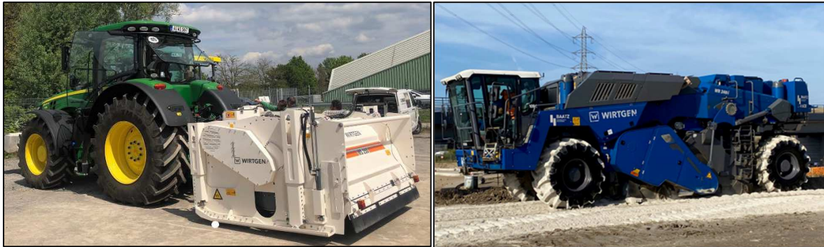
Abbildung 3. Beispiele einer Bodenfräse am Traktor (links) und eines Bodenstabilisierers (rechts)
