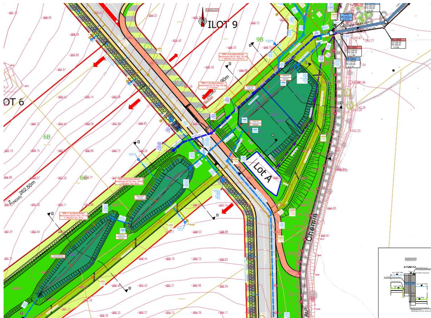
Abb. 165: Entwässerungslageplan - RRB 2 und 3 (Quelle: BEST S.à r.l. 2024, Pläne 2204a und 4202a). Größere Darstellung in Anhang 29e, Schnitte in Anhang 29f.
