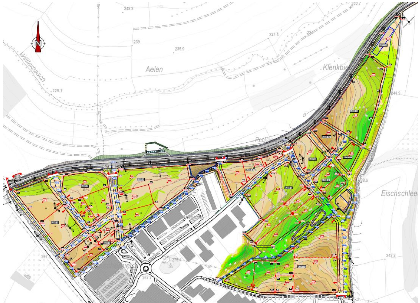
Abb. 142: Plan Terrainmodellierung – Erdmassen Ab- und Auftrag (Quelle: BEST S.à r.l. 2024). Größere Darstellung in Anhang 21a.
