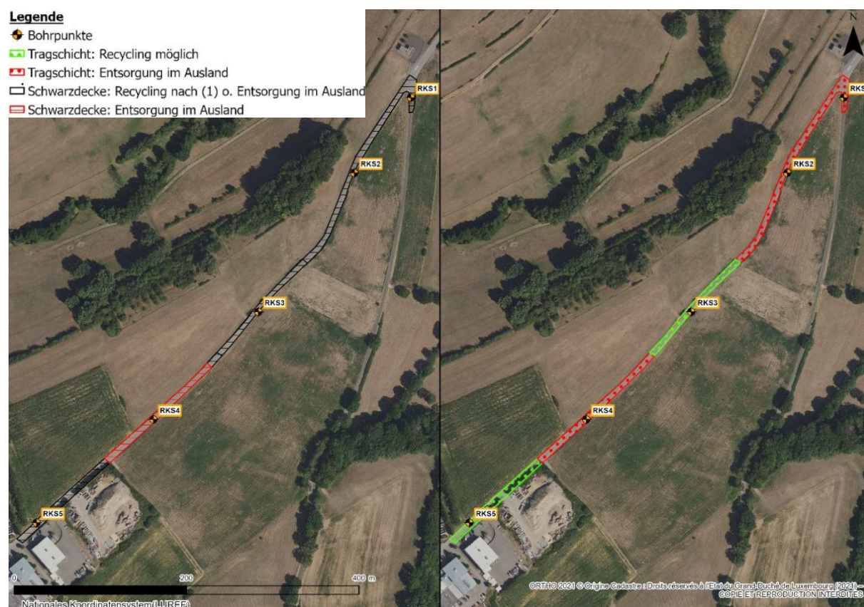
Abb. 153: Darstellung der Entsorgungsnotwendigkeit oder Recyclingmöglichkeit des Straßenbaumaterials (links Schwarzdecke, rechts Tragschicht) des Abschnitts Um Mierscherbiert (Quelle: Géoconseils S.A. 2023). Größere Darstellung in Anhang 20.
