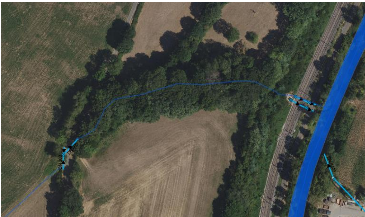
Abb. 143: Talweg mit temporärem Bachlauf und bestehenden Regenwasserleitungen entlang des Hangs östlich der Planzone (Quelle: SIGcom 2024).
