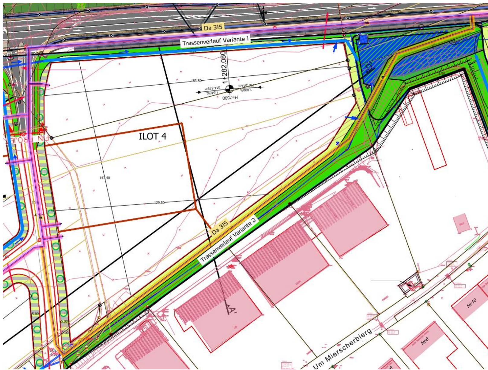
Abb. 51 Detail (Zentrum) des geplanten Trassenverlaufs des Fernwärmenetzes im PAP ECO-r1/-c1 Mierscherdall (Quelle: Luxenergie S.A. 2023). Größere Darstellung in Anhang 23f.
