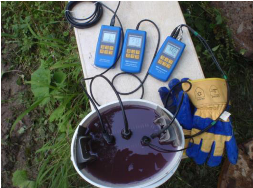
Abbildung 7: Schöpfprobe aus GWM3 vom 27.07.2016 - rötlichviolette Färbung durch Tracer Rhodamin B
