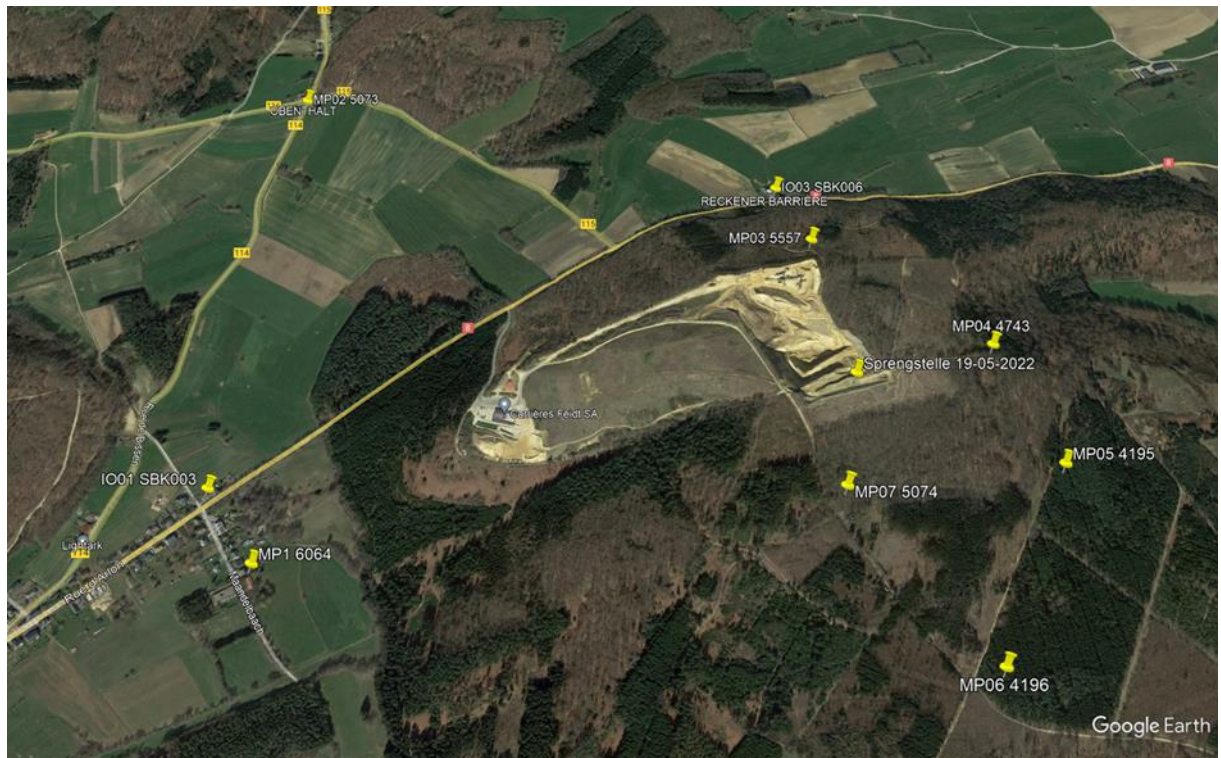
Abbildung 3 Lageplan der sprengbegleitenden Erschütterungsmessungen der Lockerungssprengung am 19-05-2023.
